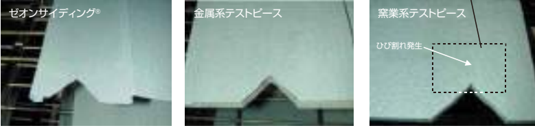
●ゼオンサイディング®・金属テストピースには変化が見られないが窯業系テストピースには、切欠き部にヒビ割れが発生する。 ※当社研究所による実験結果
